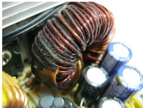
Проверка исправности трансформатора нужно начинать с внешнего осмотра. На этом этапе выявляются механические дефекты. Не существенные можно сразу устранять. Проверка на короткое замыкание между обмотками и обмоткой с корпусом выполняется при помощи мультиметра.
