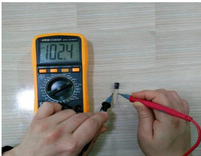
**ВАЖНО:** Если во время касания щупами конденсатора, мультиметр пищит и показывает ноль, то это говорит о коротком замыкании в конденсаторе. Если мультиметр сразу показывает единицу, то в конденсаторе случился обрыв. В любой из описанных ситуаций, следует выкинуть конденсатор, поскольку он не рабочий.
